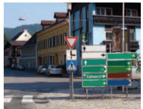
Hinweisschilder und Werbetafeln als Sichtbehinderung
