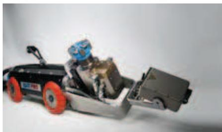
**Abb. 2: Kanalroboter mit Kamera und Fräse. Der Kanalroboter ist für Fahrten im Untergrund optimiert und ermöglicht eine lückenlose digitale Dokumentation der Leitungen. Kleine Reparaturarbeiten können mit dem fahrbaren Werkzeug direkt im Rohr erledigt werden. © Strabag**
