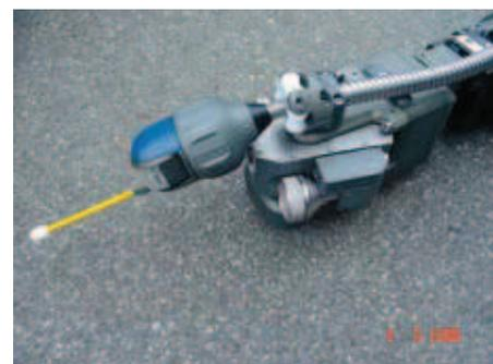
Abb. 1: Ferngesteuerte Kameras ermöglichen Einblicke in die Kanalrohre und liefern Bilder an die Oberfläche. © Hohenauer
